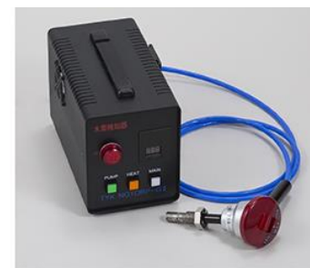
プロトン伝導性セラミックスを用いた水素警報器
